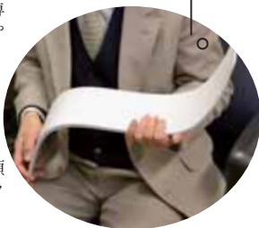
4 号機の羽根の一部。軽くて頑丈な CFRP (炭素繊維強化プラスチック) でできている
