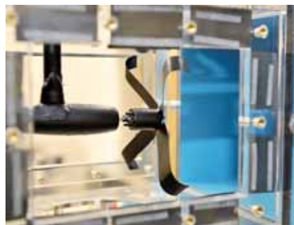
最小の直径 17 cm の風車。携帯電話の充電などに利用可
