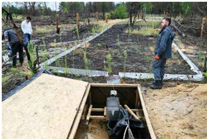
森林火災後サイトに設置した土壌浸食プロットからの試料回収
