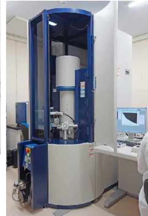
電界放出型透過型電子顕微鏡
