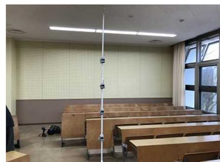
図-1 CO<sub>2</sub> センサ設置の様子
