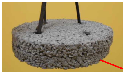
浄化能力をもつ透水性のポーラスコンクリート
