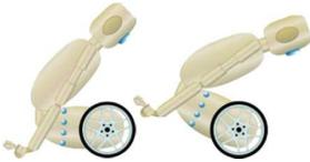
2輪倒立を行うロボットであるので、休止状態(着座)と動作状態(起立)の切り替えが必要。安定かつ高速な切り替えを実現。
