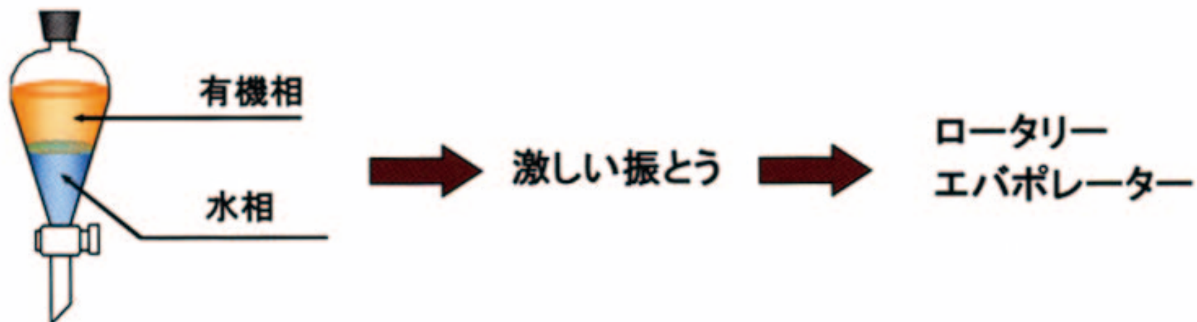
図7-1 均一液液抽出法の模式図と従来の溶媒抽出法との比較
