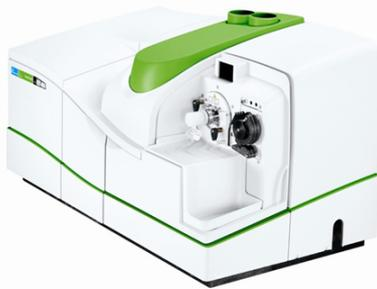
(左図) 分析システムの基盤技術である ICP-MS
