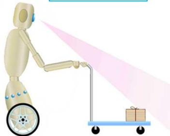
自重の約50%程度の重量がある荷物の運搬作業を実現。
